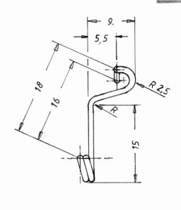
Federstecker - Montage am Beispiel ASW 22 / ASH 25 am L'HOTELLIER-Schnellverschluß der Wölbklappen-Stoßstange IX, AS-Nr. 220.45.0047 Flügel - Flügel - Trennstelle bei 3,8 m, rechts. Linke Seite spiegelbildlich montieren!
