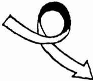
Der positive Looping kann ab 180 km/h Eintrittsgeschwindigkeit im unteren Punkt geflogen werden, jedoch werden 200 km/h empfohlen.
