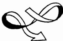
Diese Figur läßt sich mit Eintrittsgeschwindigkeiten von 160 km/h und mehr im Kreuzungspunkt fliegen. Mit etwa 190 km/h Eintrittsgeschwindigkeit ist das Manöver aber einfacher zu fliegen und sieht schöner aus. Ein Wollfaden auf der Haube hilft sehr, Schieberzustände zu vermeiden.
