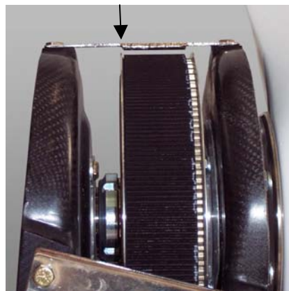
Leerlauf, der Riemen befindet sich an der hinteren Bordscheibe
