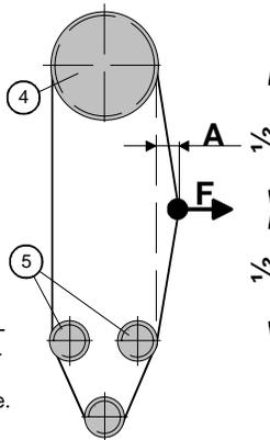
Die seitliche Auslenkung des Riemens, gemessen an einem Messpunkt in der Mitte zwischen der unteren Leitrolle [5] und der oberen Riemenscheibe [4], soll bei einer Zugkraft von  $F=58 \text{ N}$  etwa  $9 \text{ mm}$  [A] betragen.
