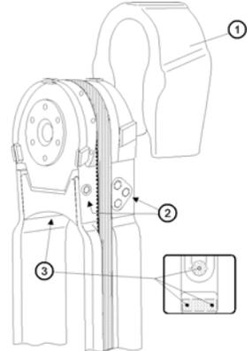
**Voreinstellung:** Bevor die Riemenspannung über die Eigenfrequenz exakt eingestellt wird, erfolgt eine Voreinstellung mithilfe einer Federwaage.
