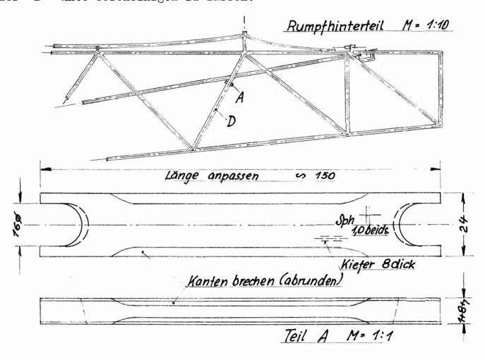
Teil A so in die beiden V - förmigen Diagonalstäbe D einsetzen, daß die Höhenruder-Stoßstange in ihrer tiefsten Stellung gerade noch frei geht (Abstand etwa 1 mm). Teil A muß stramm in den Rohren sitzen, ohne die Rohre zu beschädigen oder zu verbiegen. Die Enden werden dann mit Sickelband und Klebelack festgelegt.
