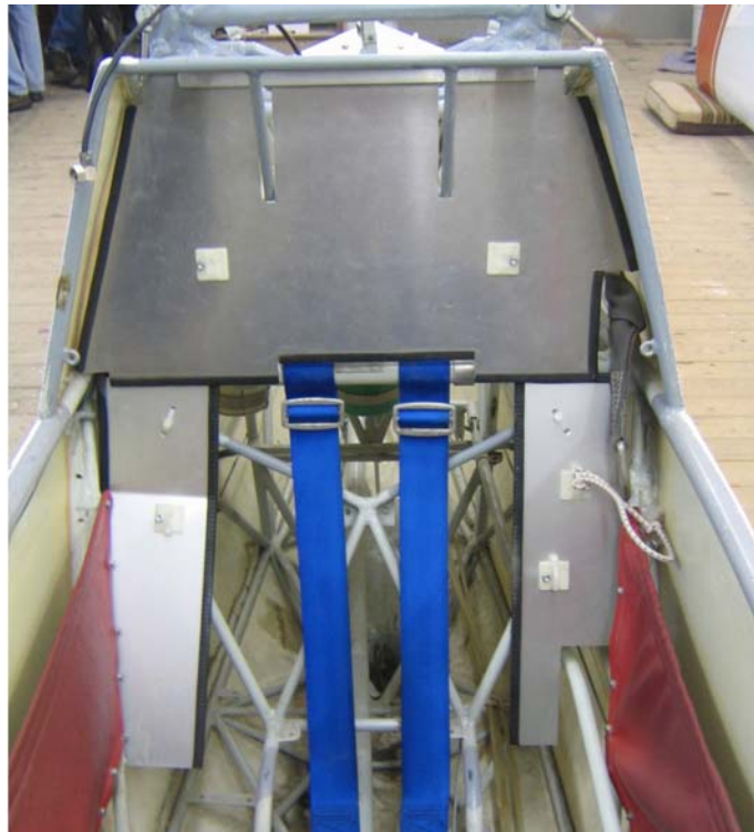
Das Luftschott hinter dem Pilotensitz, die Bohrungen für den Lautsprecher sind noch nicht gebohrt The separation behind the pilot's seat, the holes for the speaker are not yet drilled
