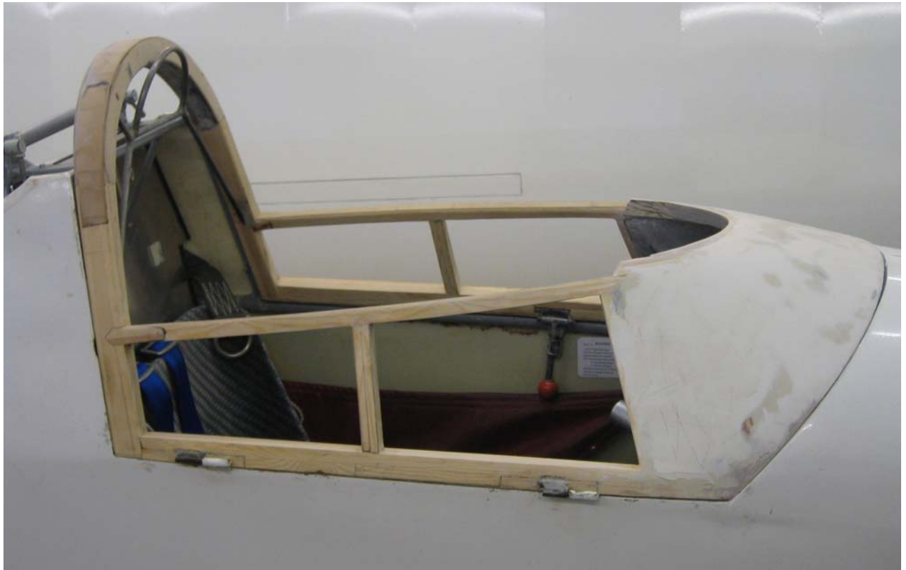
Der Haubenrahmen im Rohbauzustand The canopy frame in an unfinished condition
