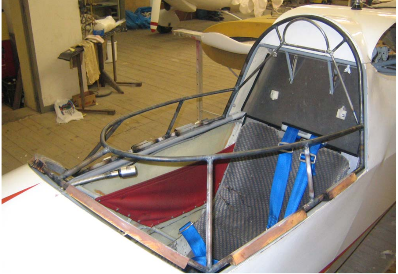
Der K 8 Haubenrahmen, in diesem Fall zurückgerüstet aus einer geschlossenen Haube The K8 canopy frame, in this particular case from a former closed canopy
