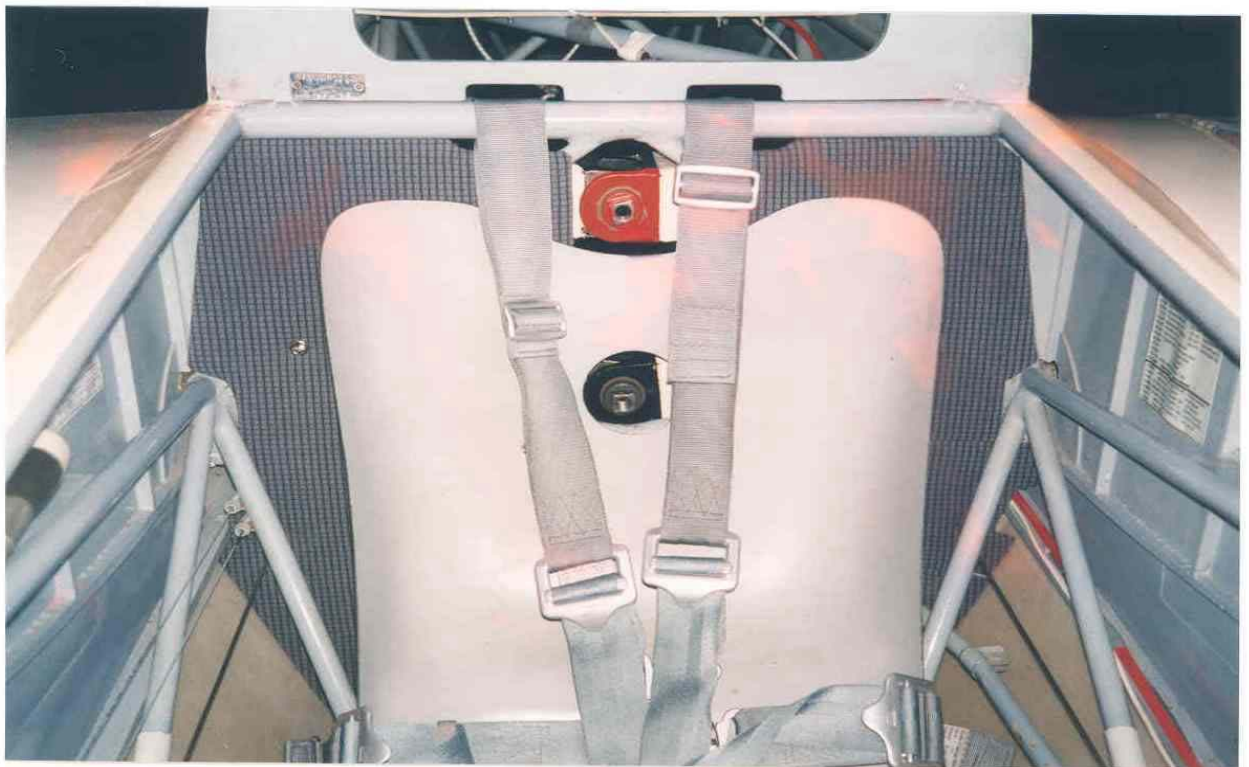
Abschottung nach hinten am Sitzspant - Sitzwanne eingebaut
