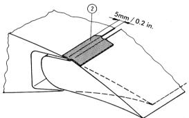
Das Dicht- und Gleitband (2) [3M Scotch, 30 mm breit] wird 5mm auf die Endfahne des Flügels und mit der anderen Seite auf das Ruder geklebt. Hierbei beachten, dass das Dicht- und Gleitband locker über dem Schlitz liegt. Das Ruder dabei auf positivste Stellung drücken, damit anschließend bei normalen Vollausschlägen der Ruder das Dicht- und Gleitband nicht spannen kann!
