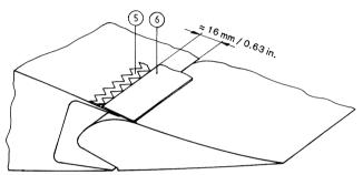
Die Schutzfolie des Abdeckbandes (6) [Mylarfolie, 22mm breit mit 15mm breiter Klebefläche] abziehen und dann das Abdeckband mit seinem Selbstklebefilm im Abstand von 16mm zur Endkante der Endfahne aufkleben.
