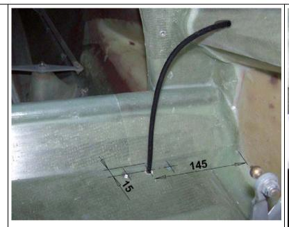
Bohrbild für die Befestigungsschrauben und die Kabeldurchführung:
