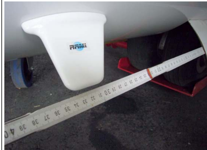
Antennenposition ca. 320 mm hinter FW-Klappe
