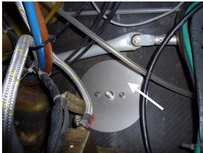
Blickrichtung von hinten durch den Brandspant. Antenne sitzt rechts neben der Kraftstoffpumpe.
