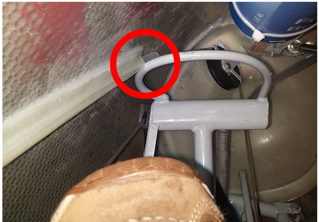
Abb. 1: Mögliches Verklemmen des Seitenruderpedals an der Seilführung des Kupplungsseilzugs
