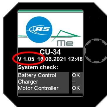
Die aktuelle Software-Version muss mit einer der zulässigen Versionen in der folgenden Tabelle 1 übereinstimmen. Ist dies nicht der Fall muss die Software bis zur nächsten planmäßigen Wartung des Antriebssystems aktualisiert werden.
