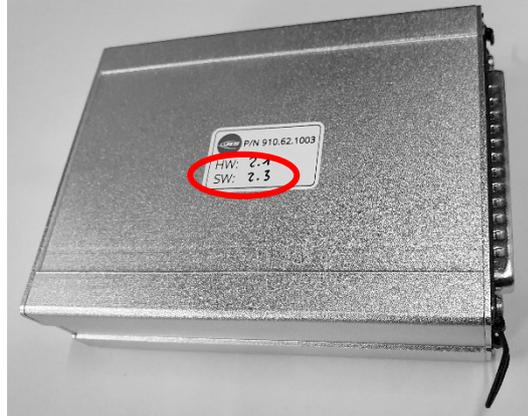
Die aktuelle Software-Version muss mit eine der zulässigen Versionen in der folgenden Tabelle 2 übereinstimmen. Ist dies nicht der Fall muss die Software bis zur nächsten planmäßigen Wartung des Antriebssystems aktualisiert werden. Nach dem Update muss die neue Software-Version zwingend auf dem Label vermerkt werden!
